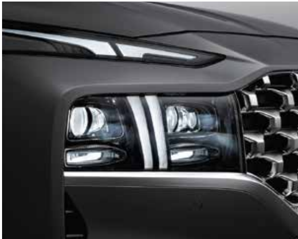
Dải Đèn ban ngày thiết kế theo chữ T kéo từ nắp capo xuống hết cụm đèn chiếu sáng
